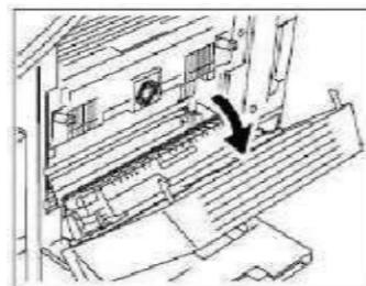
2- Mở phần giữa máy chứa thanh cao áp dưới
